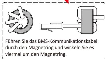
Führen Sie das BMS-Kommunikationskabel durch den Magnetring und wickeln Sie es viermal um den Magnetring.
