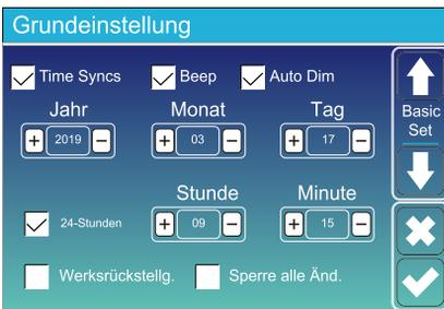
**Werksrückstellung:** Alle Parameter des Wechselrichters zurücksetzen.
