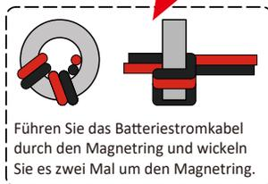
Führen Sie das Batteriestromkabel durch den Magnetring und wickeln Sie es zwei Mal um den Magnetring.
